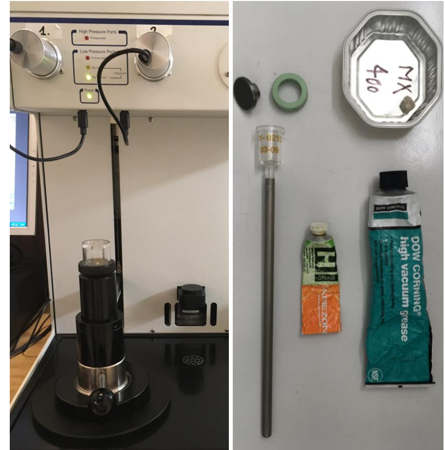
Porosimétrie au mercure sur fragment ( >1 \text{ cm}^3 )
