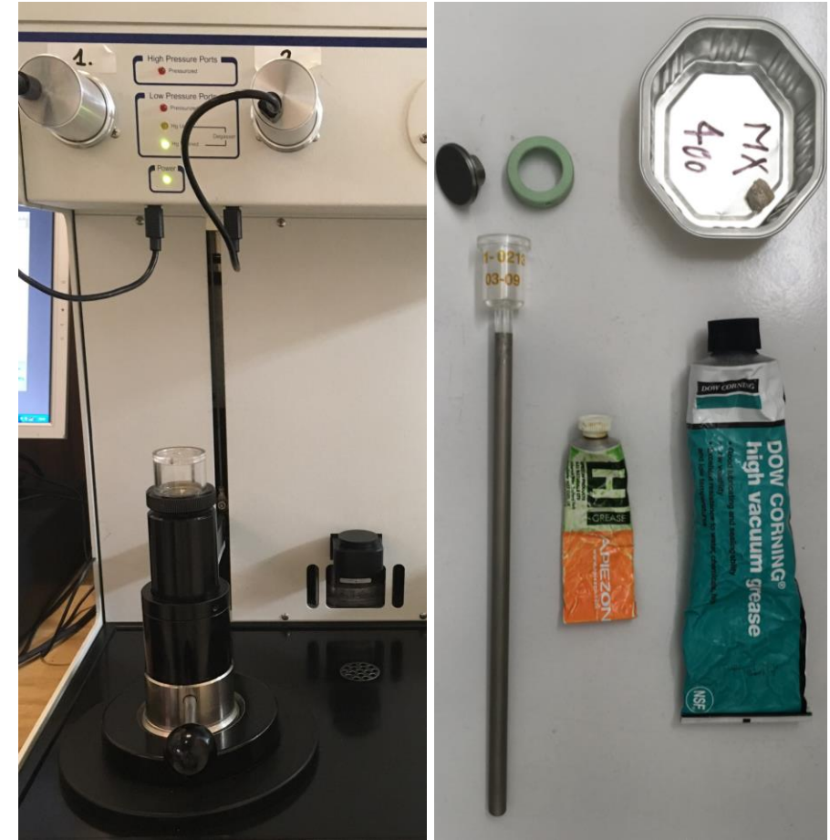
Porosimétrie au mercure sur fragment ( >1 \text{ cm}^3 )
